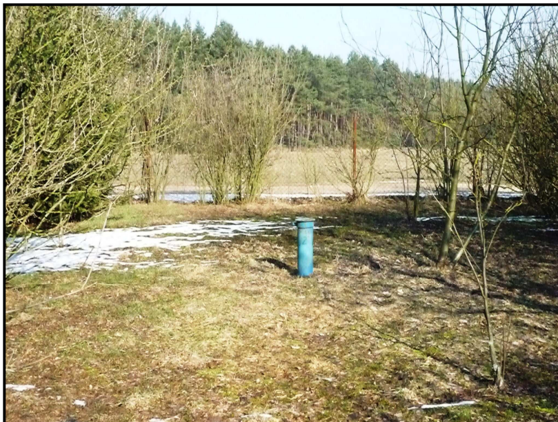
Fotografia nr 8 Monitoring wód podziemnych – piezometr P2 zlokalizowany na dopływie wód gruntowych (01.III.2011r).
